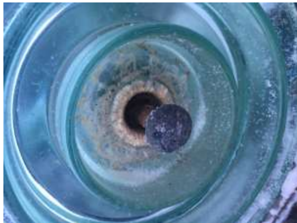
Изоляторы с загрязнением в районе цементной заделки на ВЛ 110 кВ вблизи месторождения калийных солей Пермский край, 2019г.
