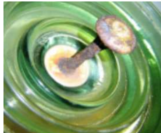
Изолятор с деградирующим стержнем в условиях воздействия химпроизводств Башкирия, Татарстан, 2025
