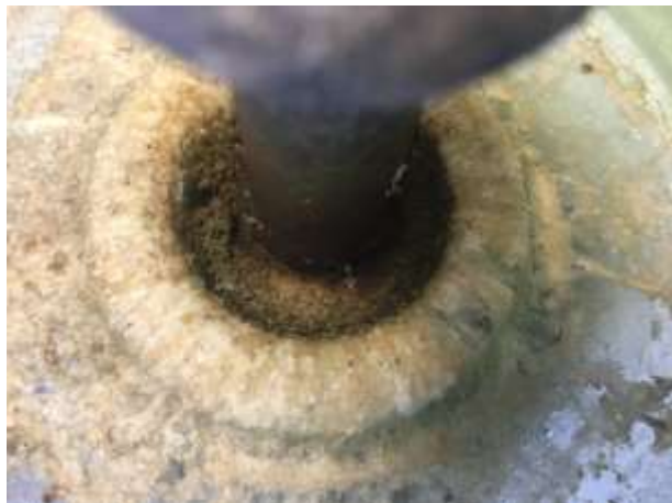
Изоляторы с загрязнением в районе цементной заделки на ВЛ 110 кВ вблизи месторождения калийных солей Пермский край, 2019г.
