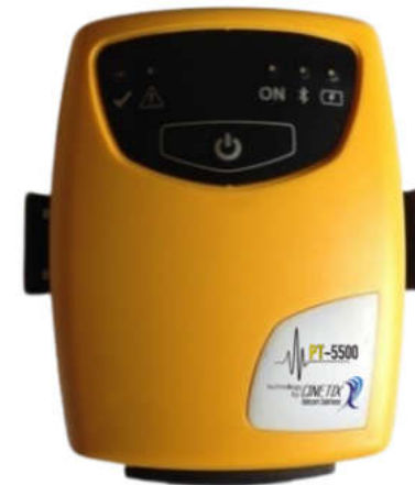
CXI-PT5500 (измерение ЧСК дер. Опор)
