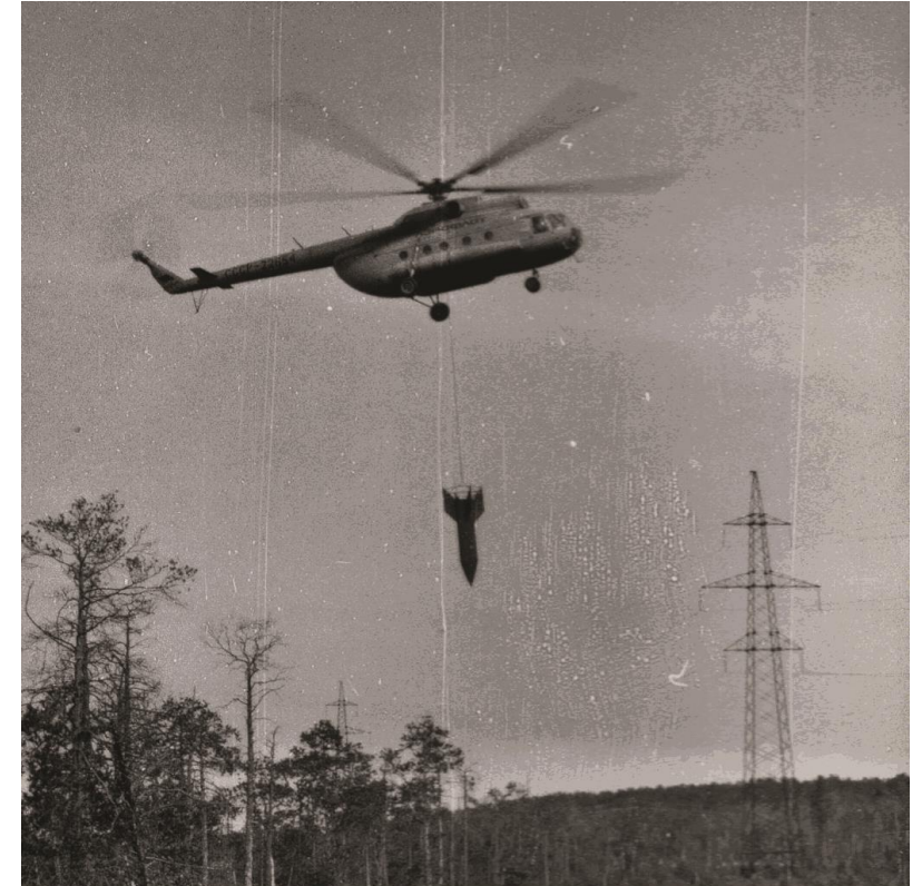
Рис.8. Испытания полового фундамента стойки ВЛ-220 кВ, сбрасываемого с заданной высоты (Сургут, 1992)
