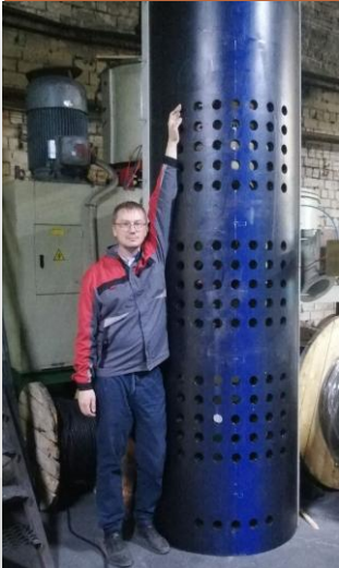
анод титановый в защитном кожухе (райзере) | А3М-РА®
