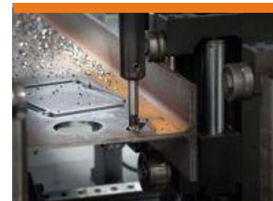
Порезка, сверление и фрезеровка балки и фасона
