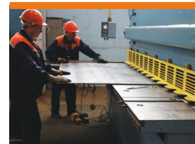
Раскрой плоского проката на гильотинных ножницах
