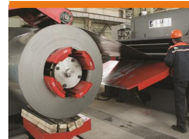
Поперечный раскрой рулонного проката
