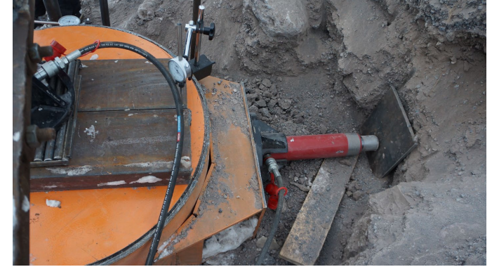
Установка для среза целика (приложение срезающей нагрузки сверху).
