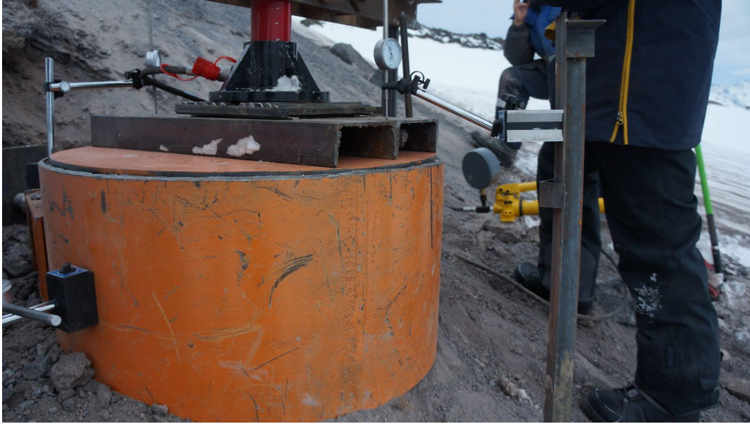
Установка для среза целика (приложение срезающей нагрузки сверху).
