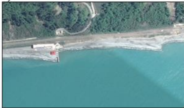
Рис. 3. Последствия устройства бун из сквозного причала на пляже пансионата «Шексна» в Лазаревском районе г. Сочи
