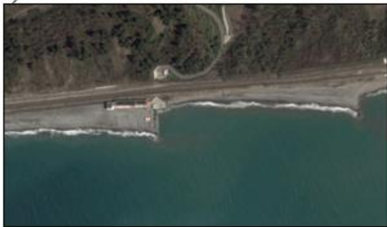
Рис. 3. Последствия устройства бун из сквозного причала на пляже пансионата «Шексна» в Лазаревском районе г. Сочи
