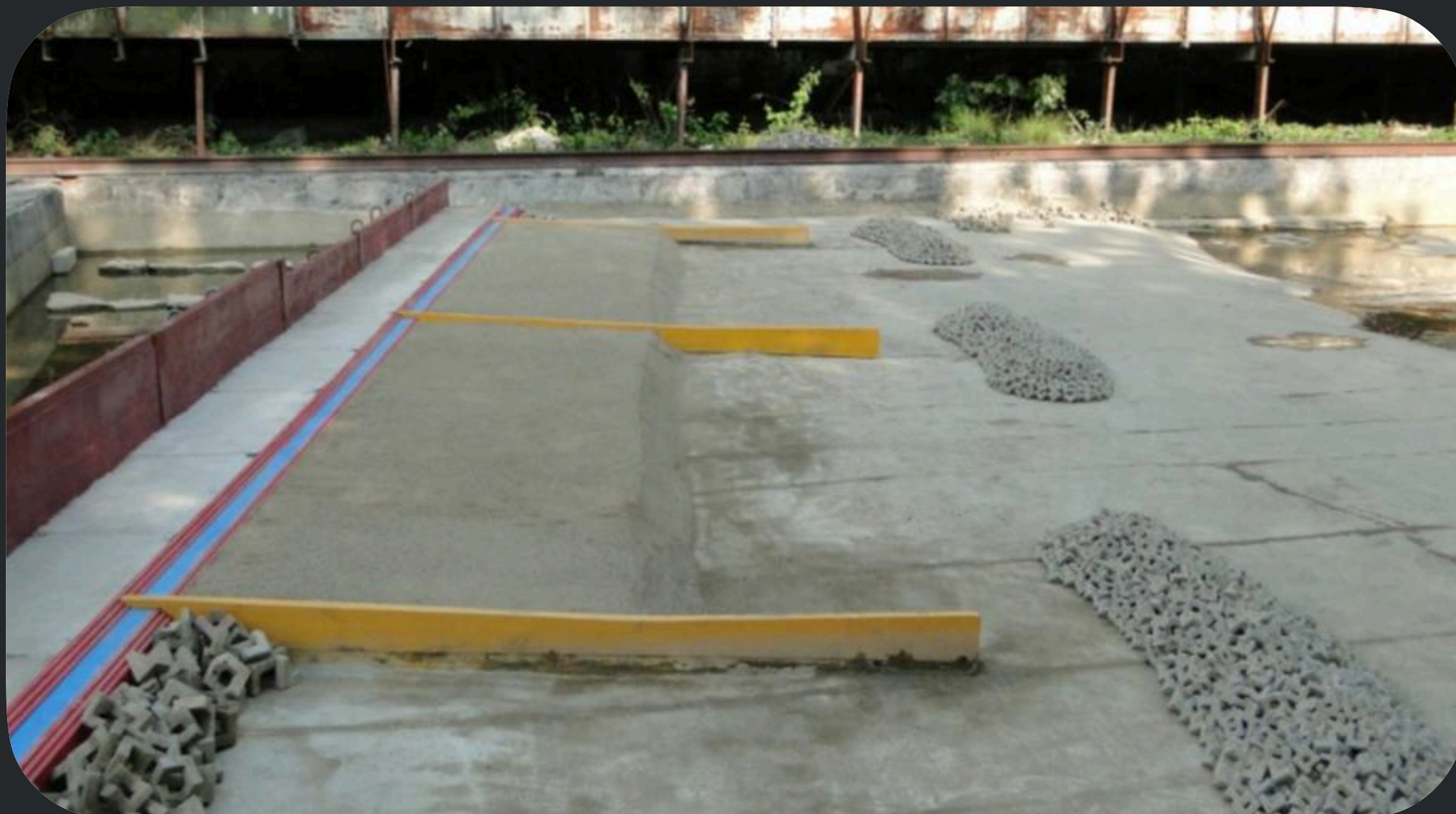
Гидравлическая модель в бассейне перед началом опытов
