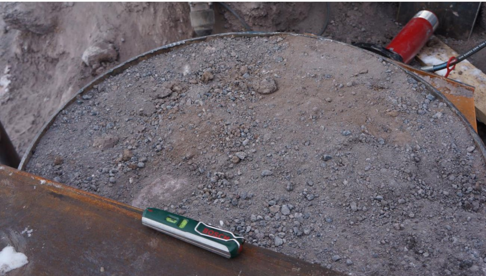
Рисунок 2.19 Кольцо, объемом 200\,000\text{ см}^3 (площадь 5000\text{ см}^2 при высоте 40 см) с грунтом.
