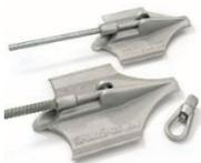
**Большие самораскрывающиеся грунтовые анкеры** – забивные поворотные анкеры с натяжением тросом или стальной тягой, нагрузкой на точку до 200 кН, для укрепления склонов, котлованов, конструкций на склонах, подводных элементов
