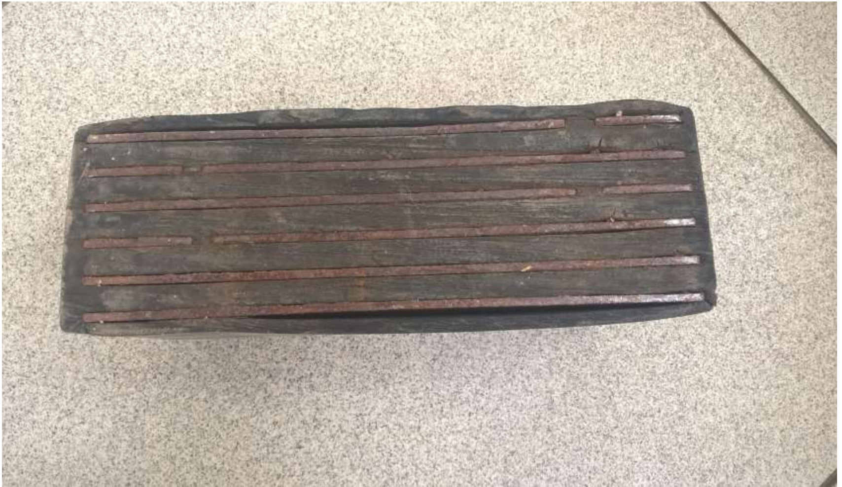
Фото разреза резиновой опорной части
