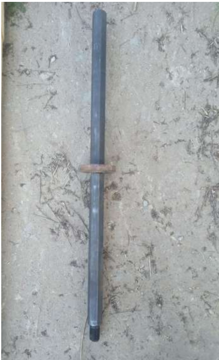
Удлинённые штанги с опорными шайбами, г.Смоленск, сентябрь 2024г.
