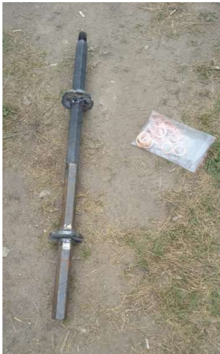
Удлинённые штанги с опорными шайбами, г.Смоленск, сентябрь 2024г.
