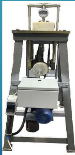
Установка для статико- динамических исследований грунтов
