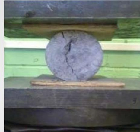
Скорость нагружения 3 мм/мин и разрушающая нагрузка для М100 (максимальная марка) порядка 73 кН указывает на использование электромеханического прессы до 100 кН
