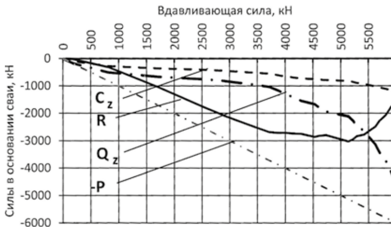
Рис. 4. Графики изменения усилий в грунтах основания висячей сваи
