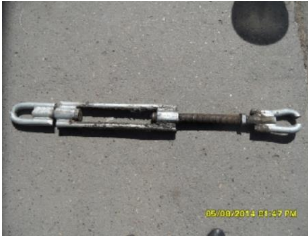
Динамический разрыв петли талрепа ветровой связи металлической многогранной опоры
