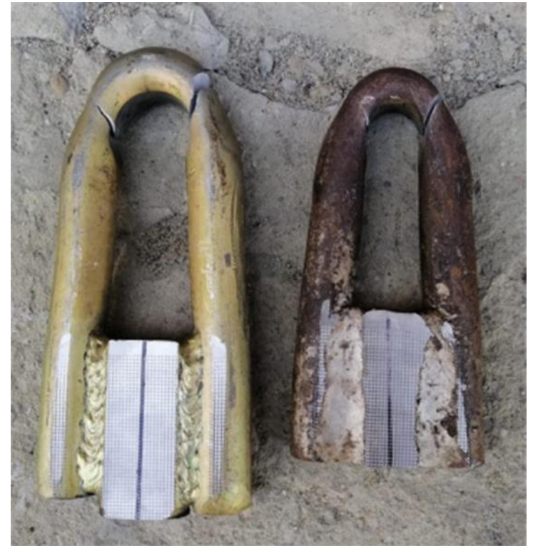
Разрыв петли талрепа ветровой связи металлической многогранной опоры при статических испытаниях (произошло вытягивание петли)
