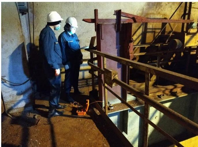
Динамические испытания ферм и подкрановых путей при проезде крана в цеху стального проката НМЛК
