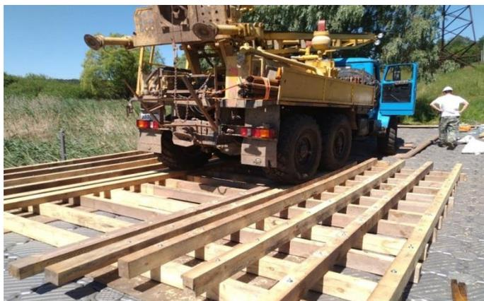
Динамические испытания понтона для возможности транспортировки и работы с понтона геологической буровой установки на Железногорском карьере по добыче железной руды
