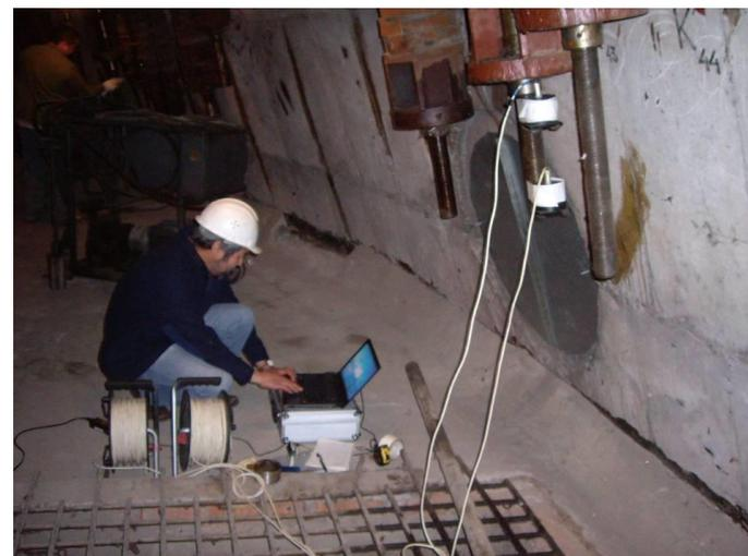
Динамические испытания тросов и шпилек для оценки технического состояния и остаточного ресурса на телебашне
