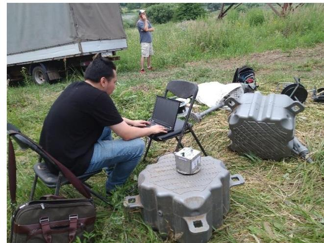
Динамические испытания отдельных блоков понтона
