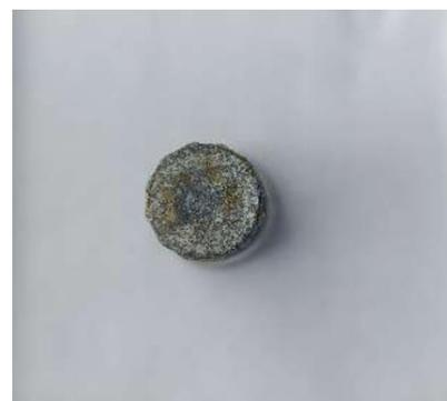
Вид образцов с термодиффузионным цинк-алюминиевым покрытием после 593 часов испытаний в КНСТ:
