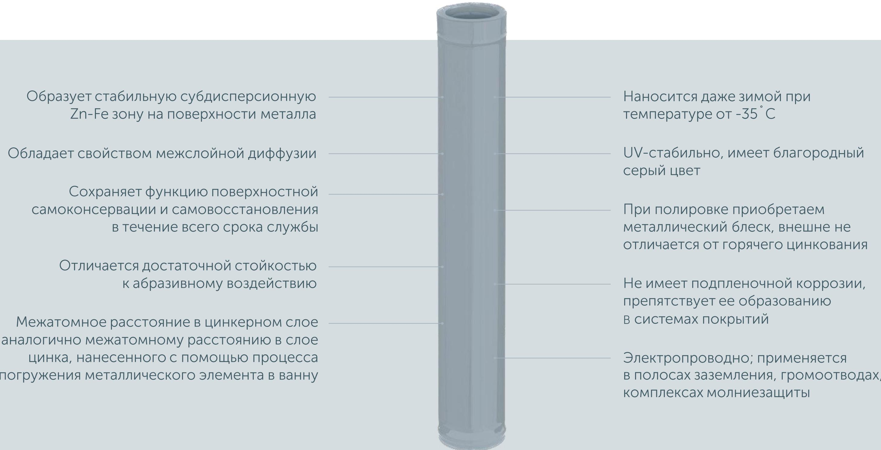
Цинкерное покрытие обеспечивает одновременно активную (катодную) и пассивную (барьерную) защиту металла от коррозии
