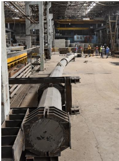
Стойка нагружена на 155% (3,21 т) Отклонение стойки на 3,2 м
