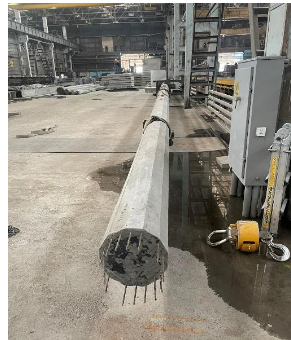
При снятии нагрузки вернулась в исходное положение без остаточных деформаций
