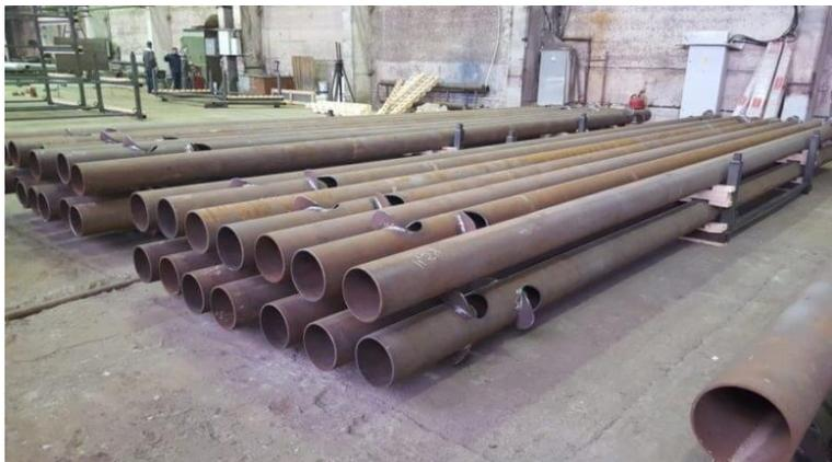
Сваи из металлических труб  $\varnothing 219$ ,  $\varnothing 325$
