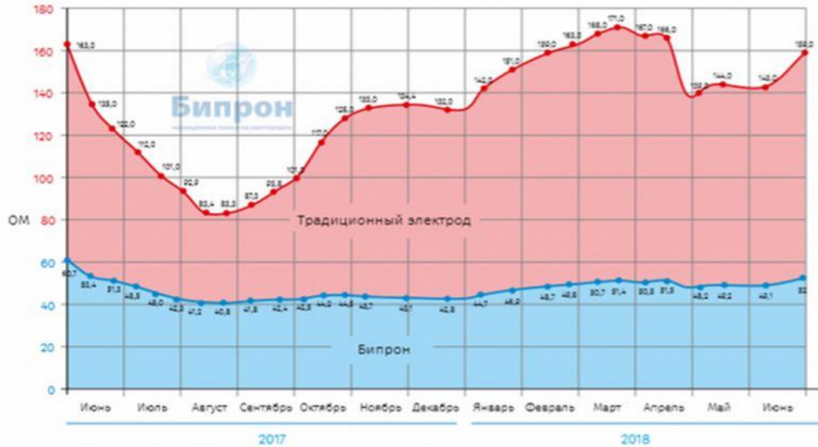
Рис. График стабильности сопротивления ЗУ из ЭЗК Бипрон по сравнению с традиционным контуром, фактические замеры ОПЭ за 2 года
