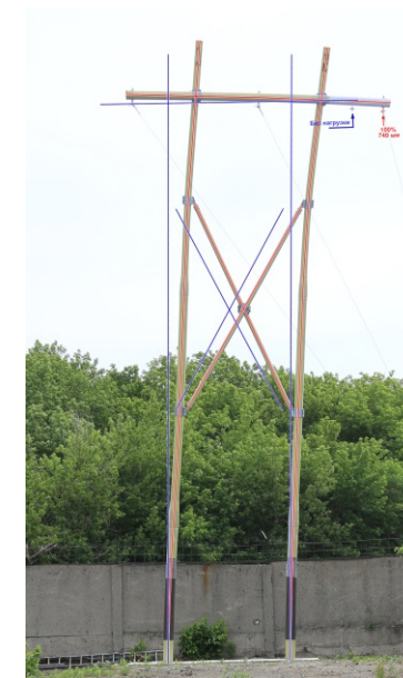
Конечно-элементная модель Проверка прочностных и деформационных характеристик Первая группа предельных состояний, нормальный гололедный режим, Fвет=3x3562 Н, Fвес=3x8527 Н
