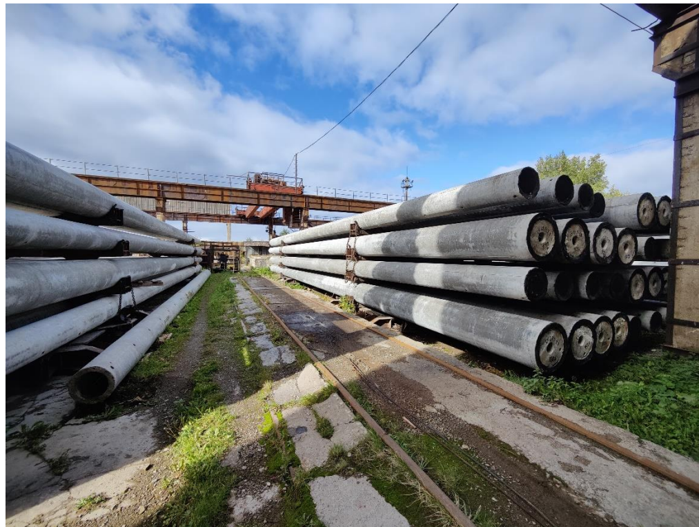
Компактное хранение ж/б опор на складах ООО «Рыбинскэнергожелезобетон»
