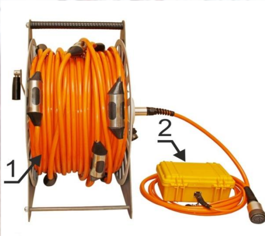
Гидрофонная коса WellStreamer (1) с аккумуляторным блоком (2) и гидрофон,
