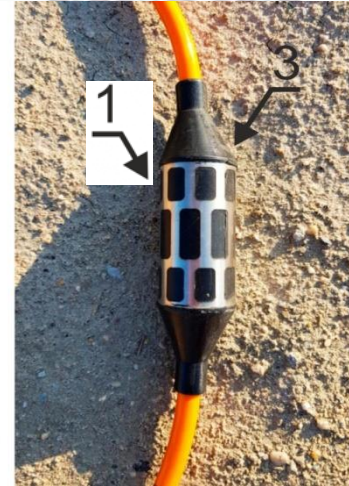
Гидрофонная коса WellStreamer (1) с аккумуляторным блоком (2) и гидрофон,
