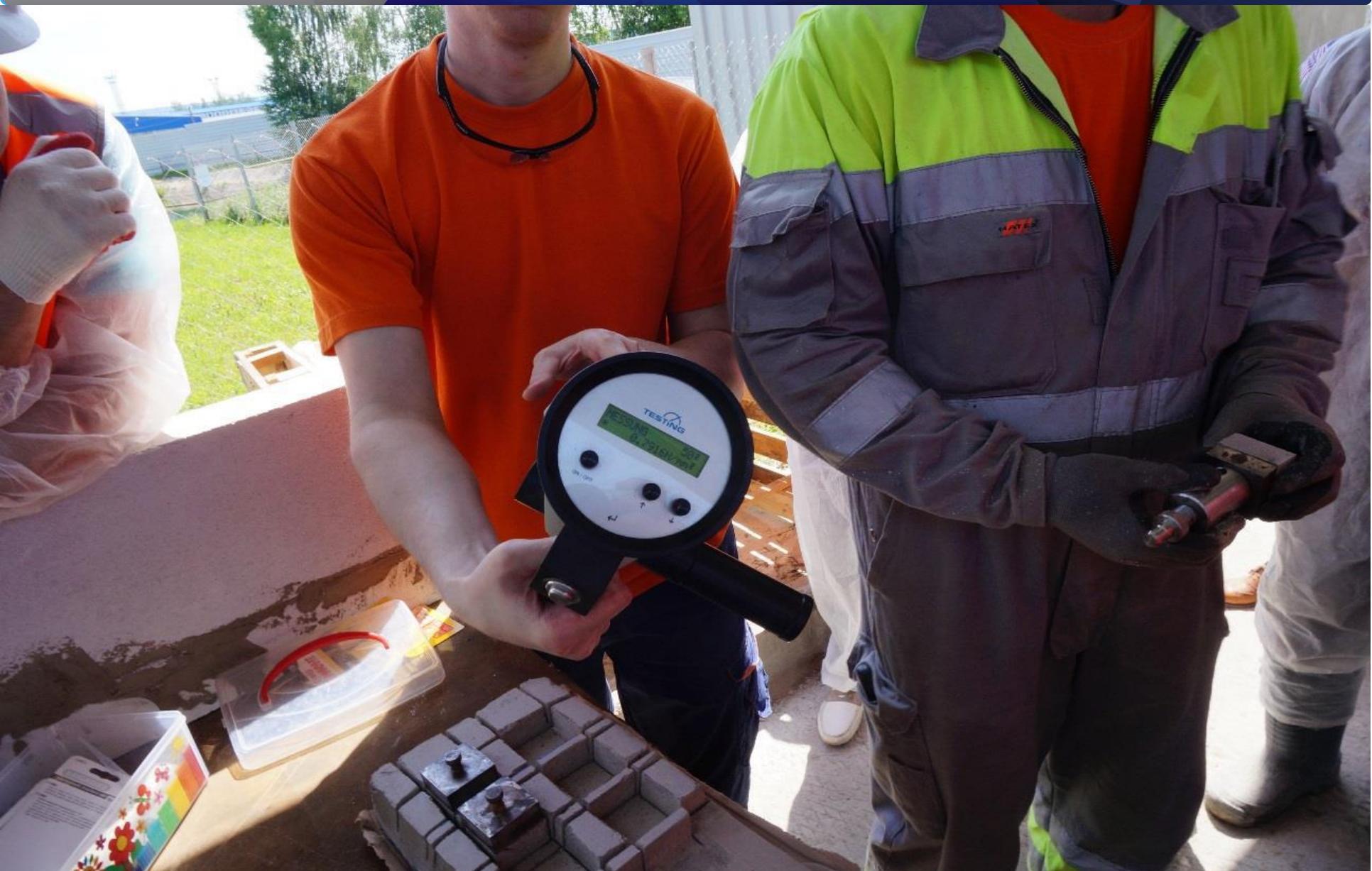
Испытание вторичной адгезии композитной гидроизоляции с двухсторонней адгезией
