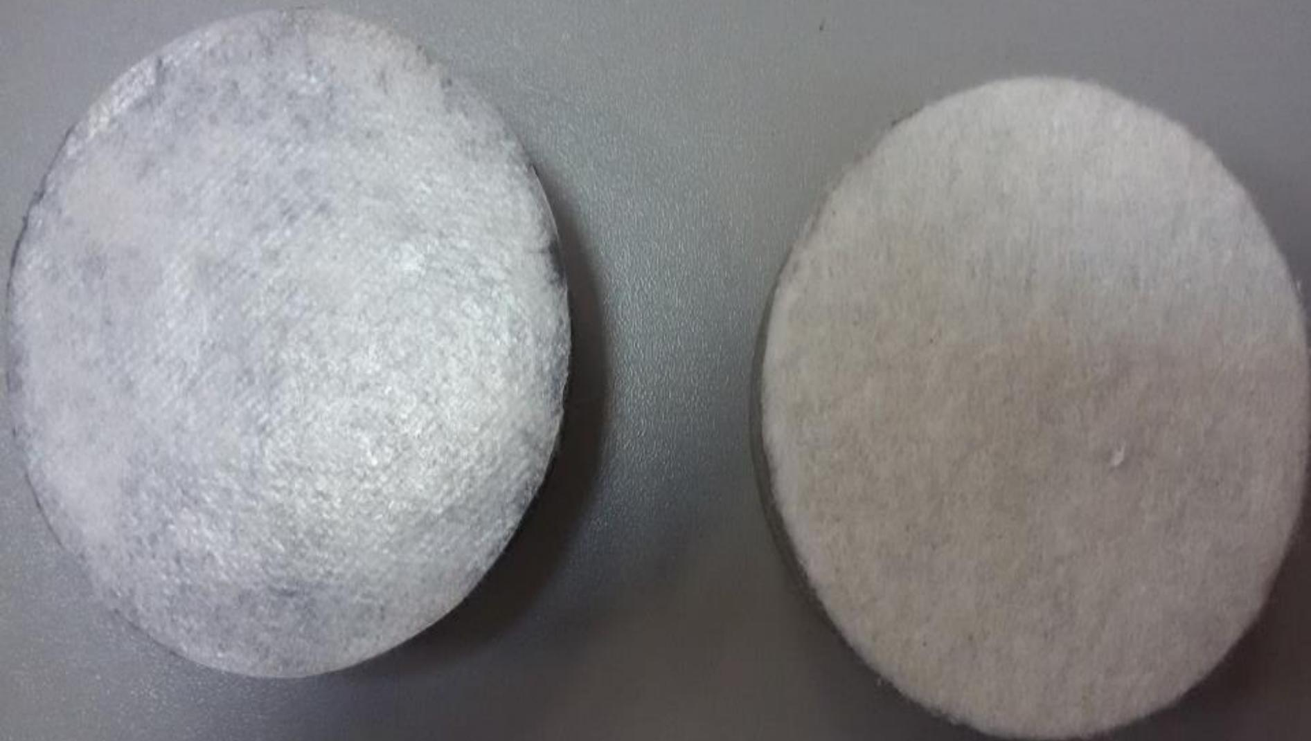
Образцы двуслойной обделки с межслойной композитной гидроизоляцией до испытаний
