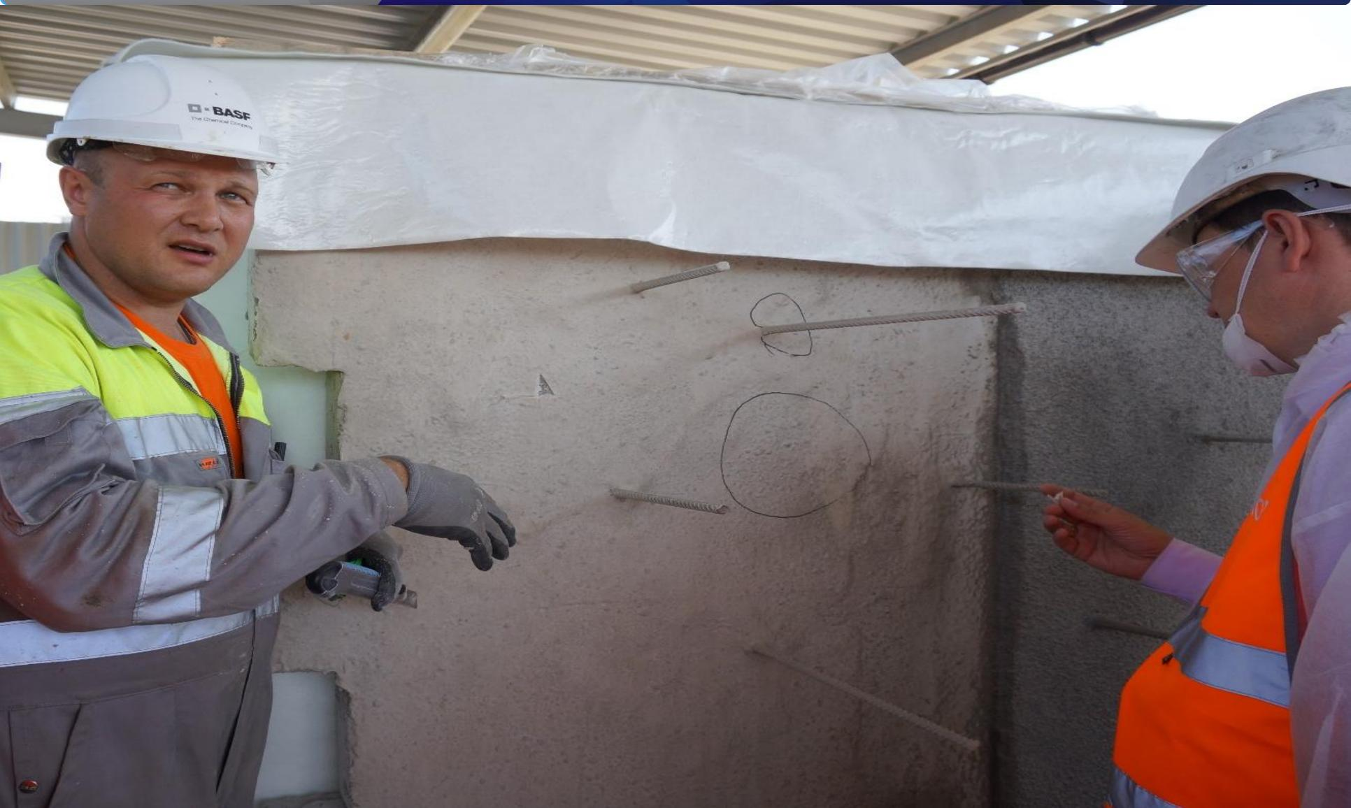
Стенд бетонного основания с выпусками арматуры, с нанесенными слоями из напыляемой гидроизоляции и последующего набрызг-бетона
