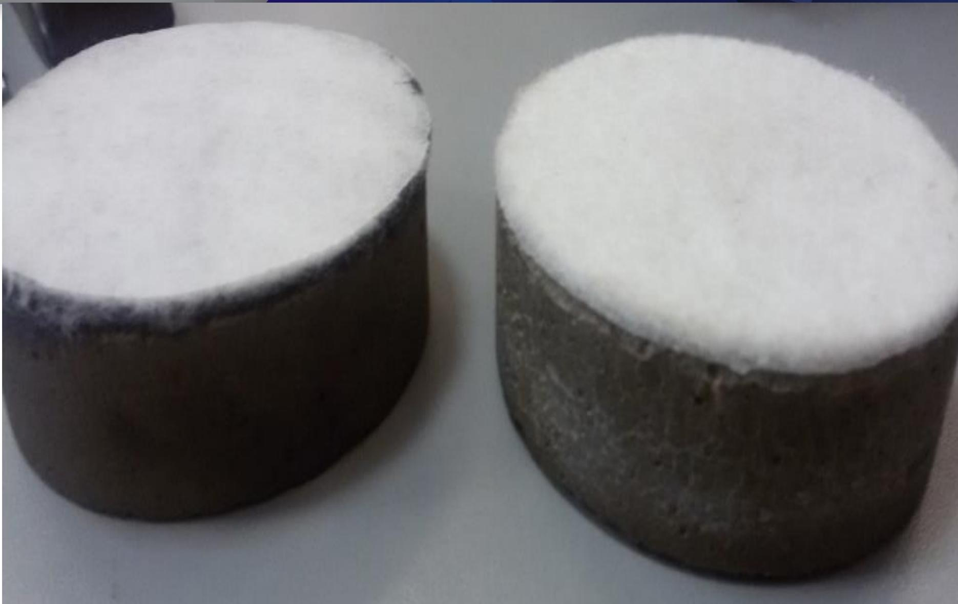
Рис. 8. Образцы двуслойной обделки с межслойной композитной гидроизоляцией после испытаний на стойкость к взаимному сдвигу под давлением
