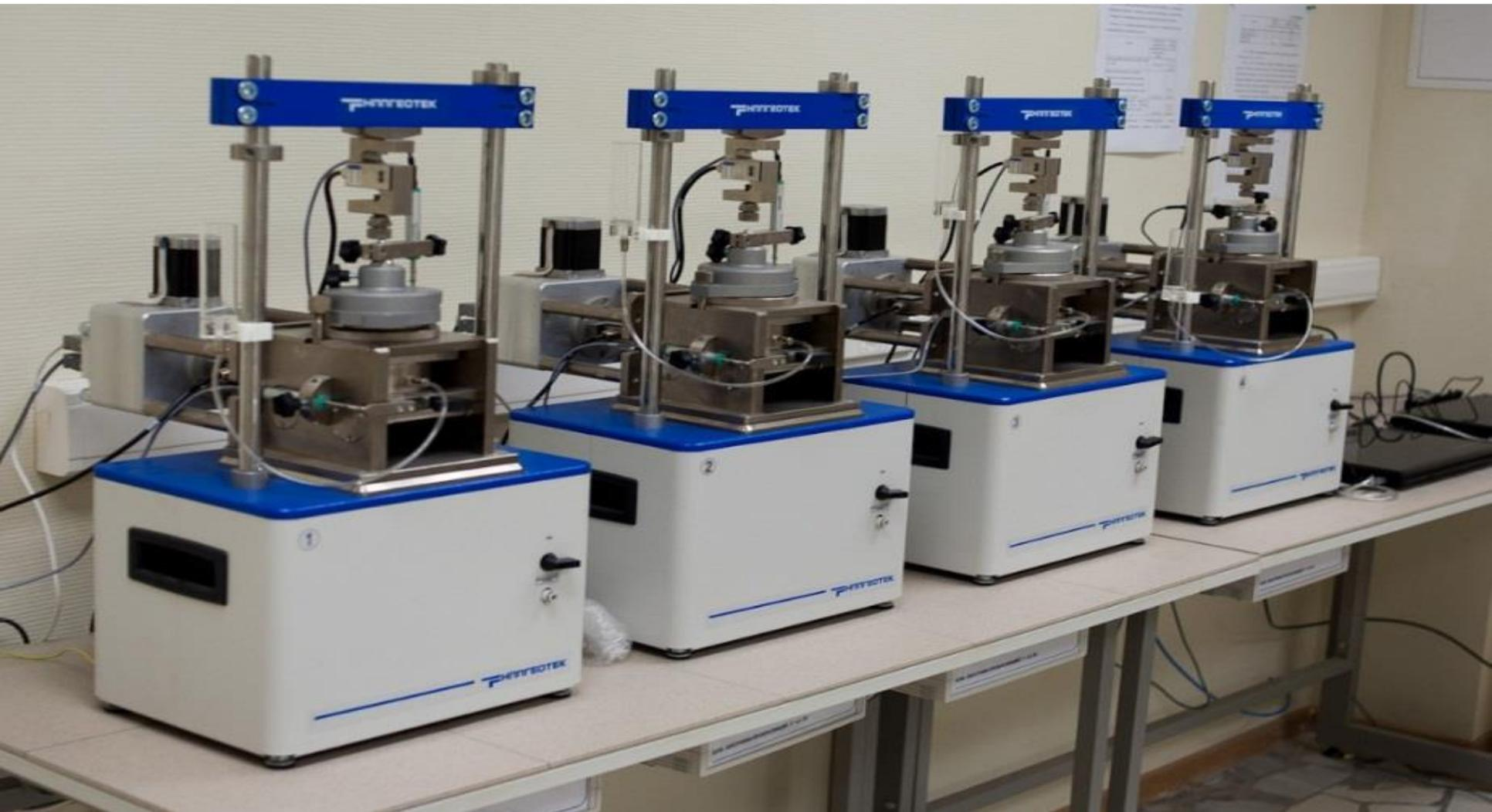
Рис. 7. Лабораторные установки МГСУ одноплоскостного среза
