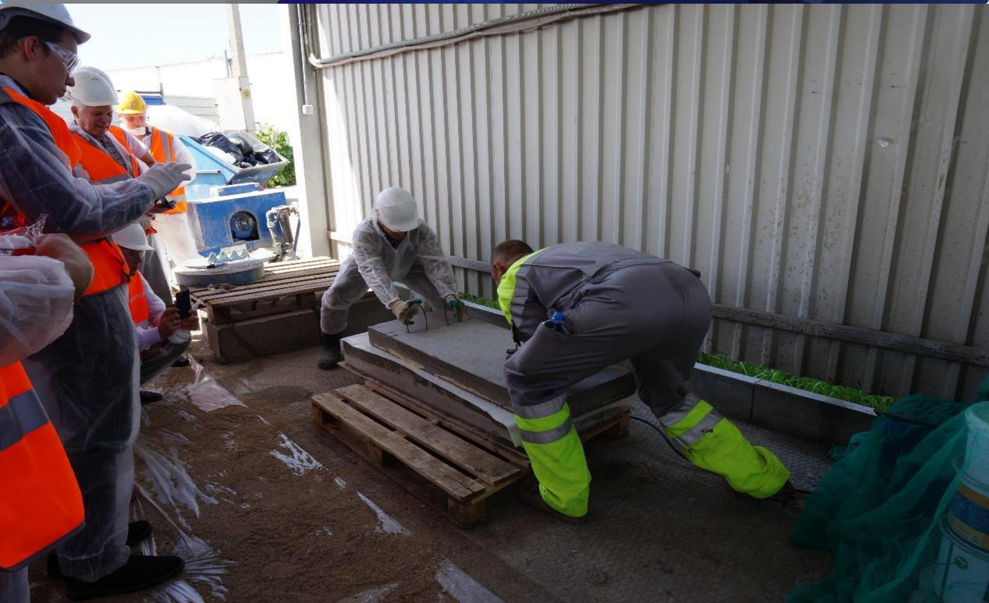
Испытание на истирание композитной гидроизоляции образца двухслойной обделки с межслойной плоскостью скольжения
