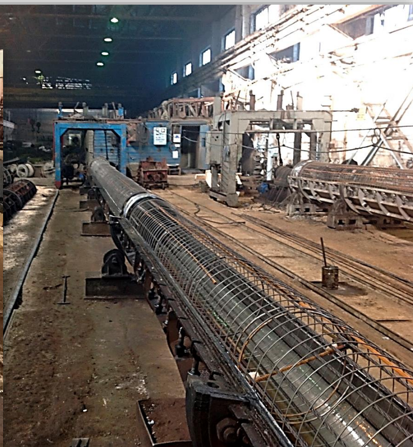
Арматурный каркас в полуформе
