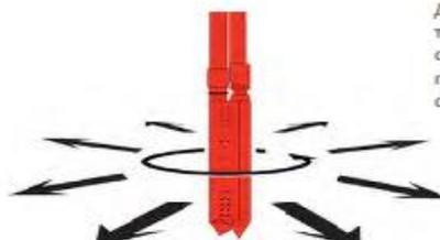
Дебаланс вибратора создаёт радиальные вибрации, которые наряду с тянущим усилием (при монтаже системы на самоходной установке) и собственной массой вибропика, позволяют проникать в грунт на заданную глубину уплотнения. Процесс погружения может сопровождаться подачей струи воды или воздуха через наконечник вибропика.
