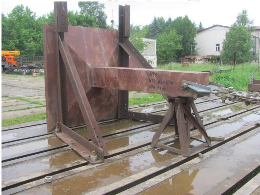
Фундамент АФ-5, нагрузка 63,4 тс
