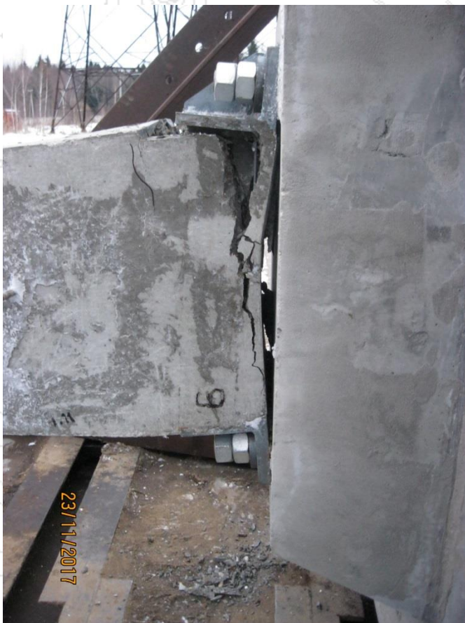
Фундамент ФМ4-32.20.20-1Б, нагрузка 145 тс (160%)
