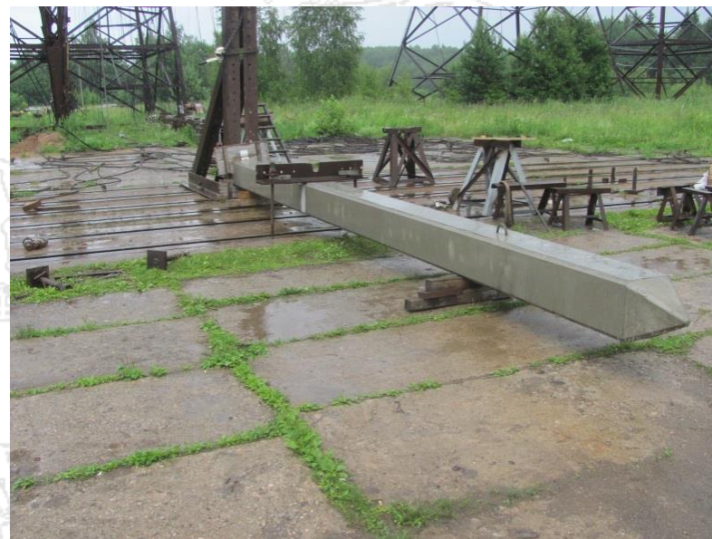
Свая С35-2-8-1, нагрузка 34,2 тс
