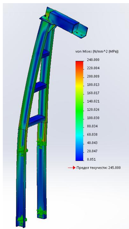
Расчет тросостойки анкерно-угловой одноцепной опоры
