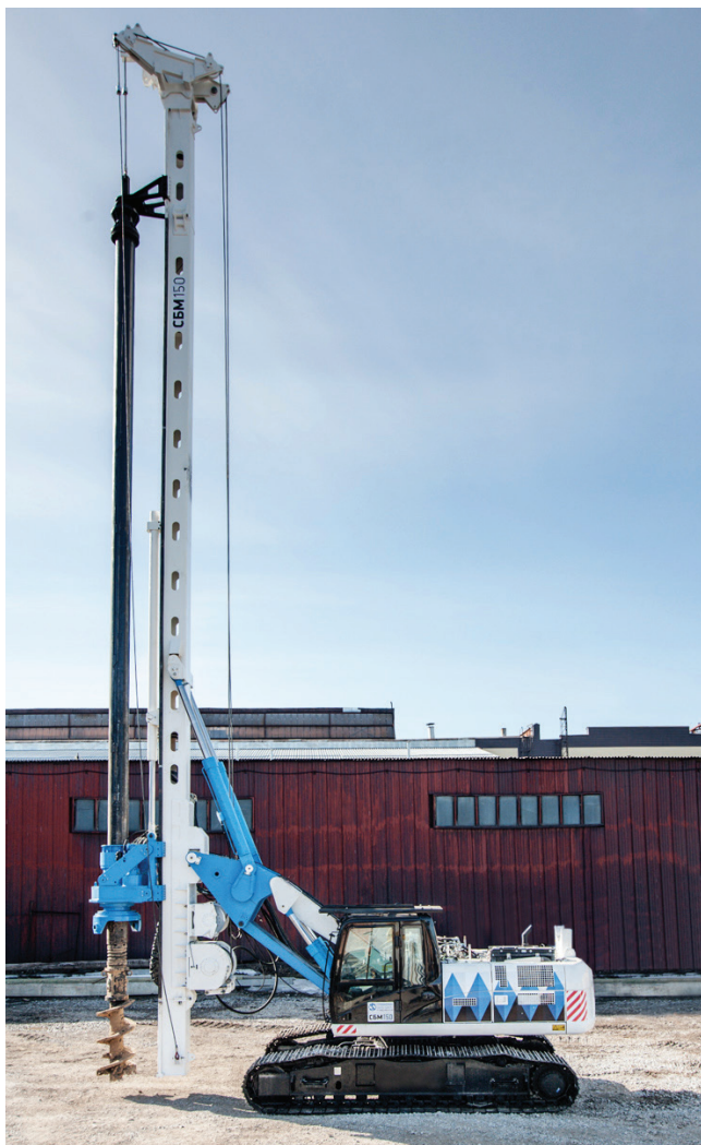
Рис. 3. СБМ150. Бурение штангой-Келли, непрерывным полым шнеком.
