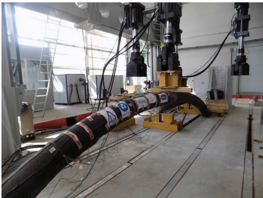
Рис. 4. Испытание конструктивно-подобного арочного несущего элемента
