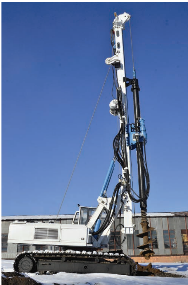
Рис. 4. СБМ80. Бурение штангой-Келли, непрерывным полым шнеком
