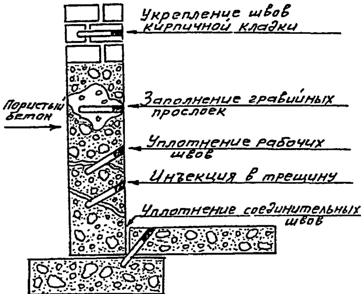
Рис. 3.5. Схема уплотнения отдельных негерметичных мест инъекции
