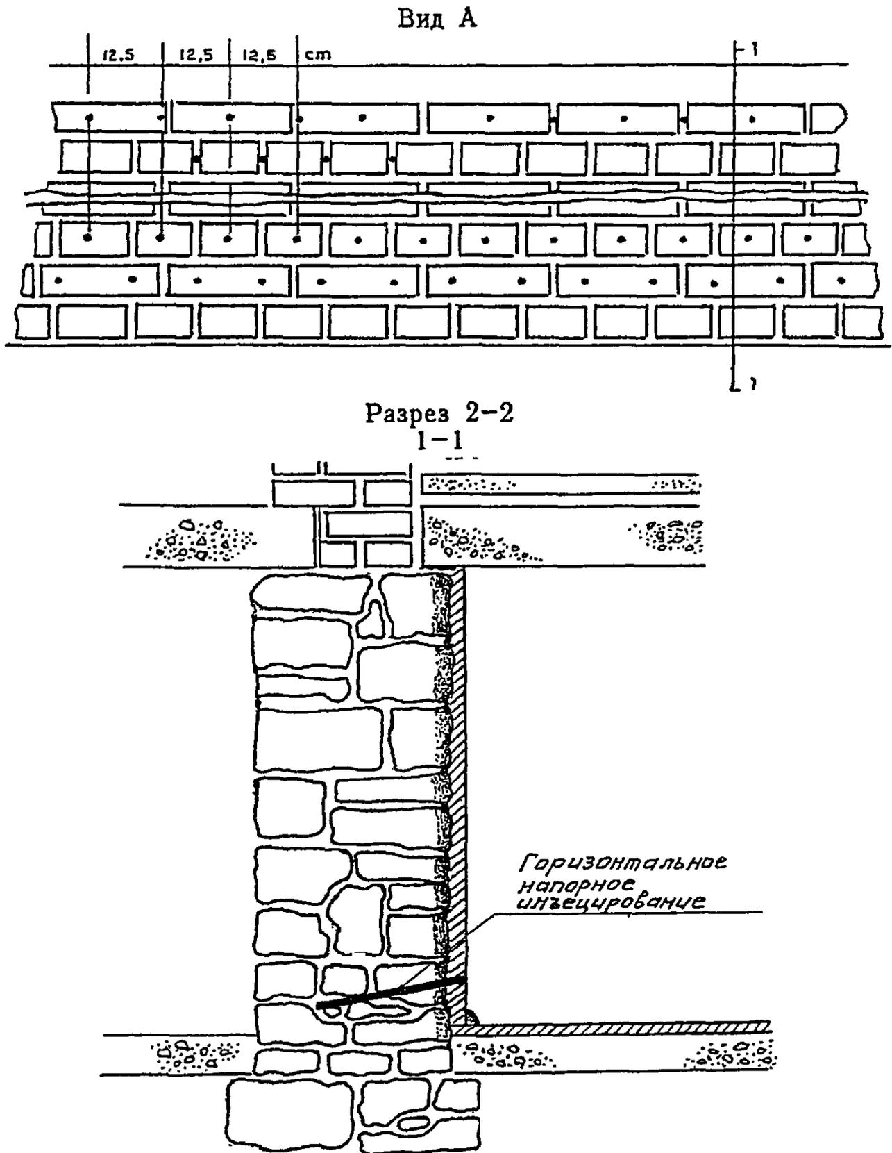
Рис. 3.2. Схема гидроизоляции подвала
