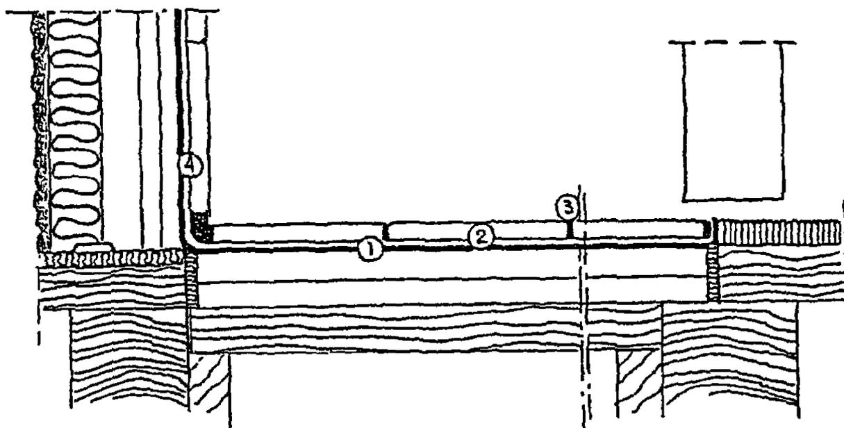
Рис. 4.4. Гидроизоляция под плитку. Постройки из легких конструкций (в частности, старые постройки):
