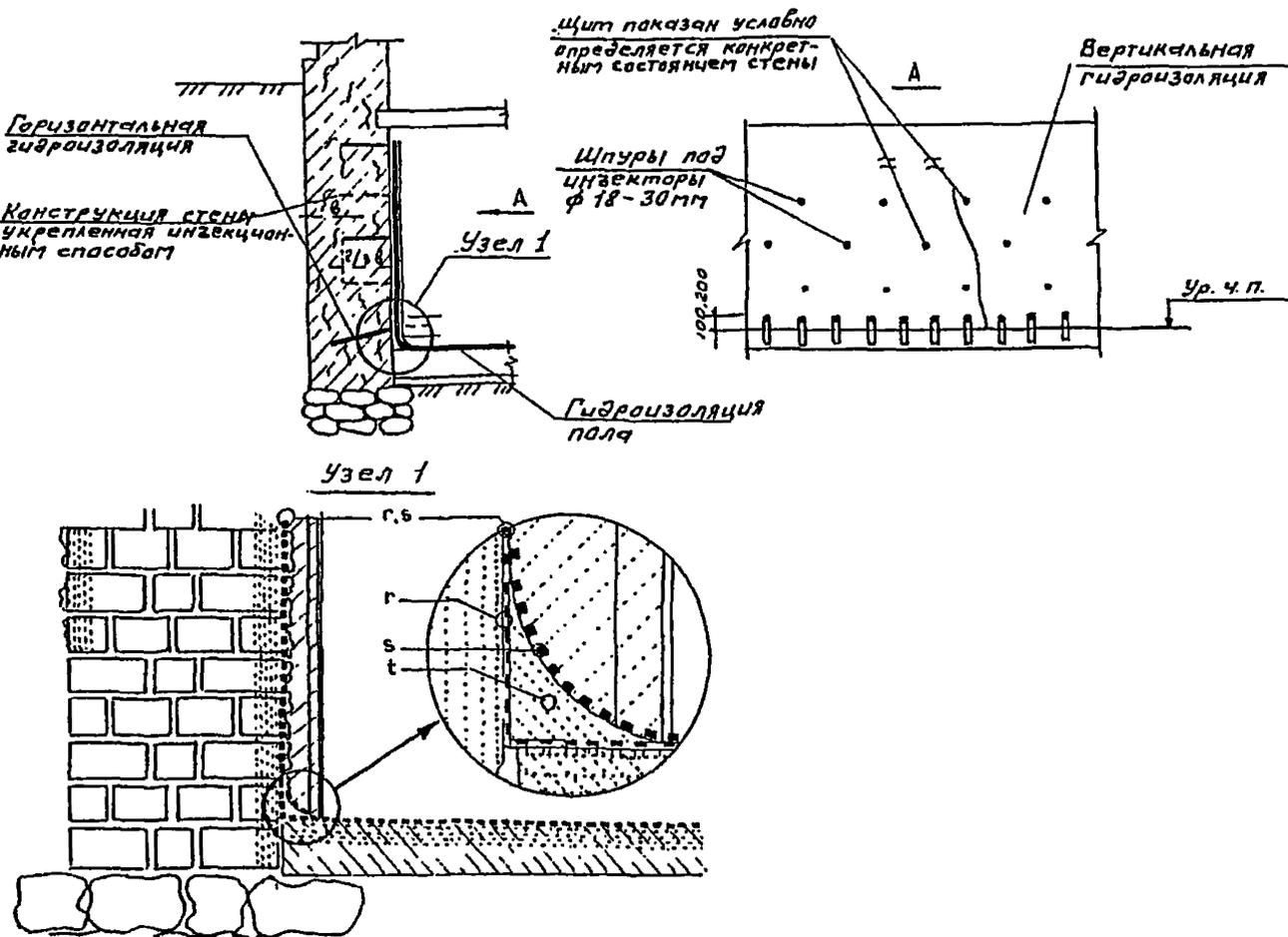
Рис. 3.7. Устройство инъекционной и покровной гидроизоляции
