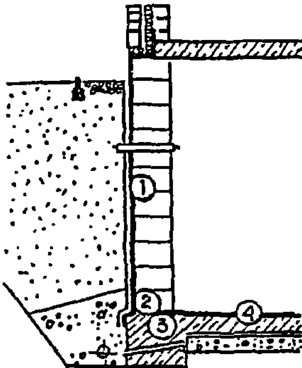
Рис. 4.1 Гидроизоляция подвалов и фундаментов в новостройках:
