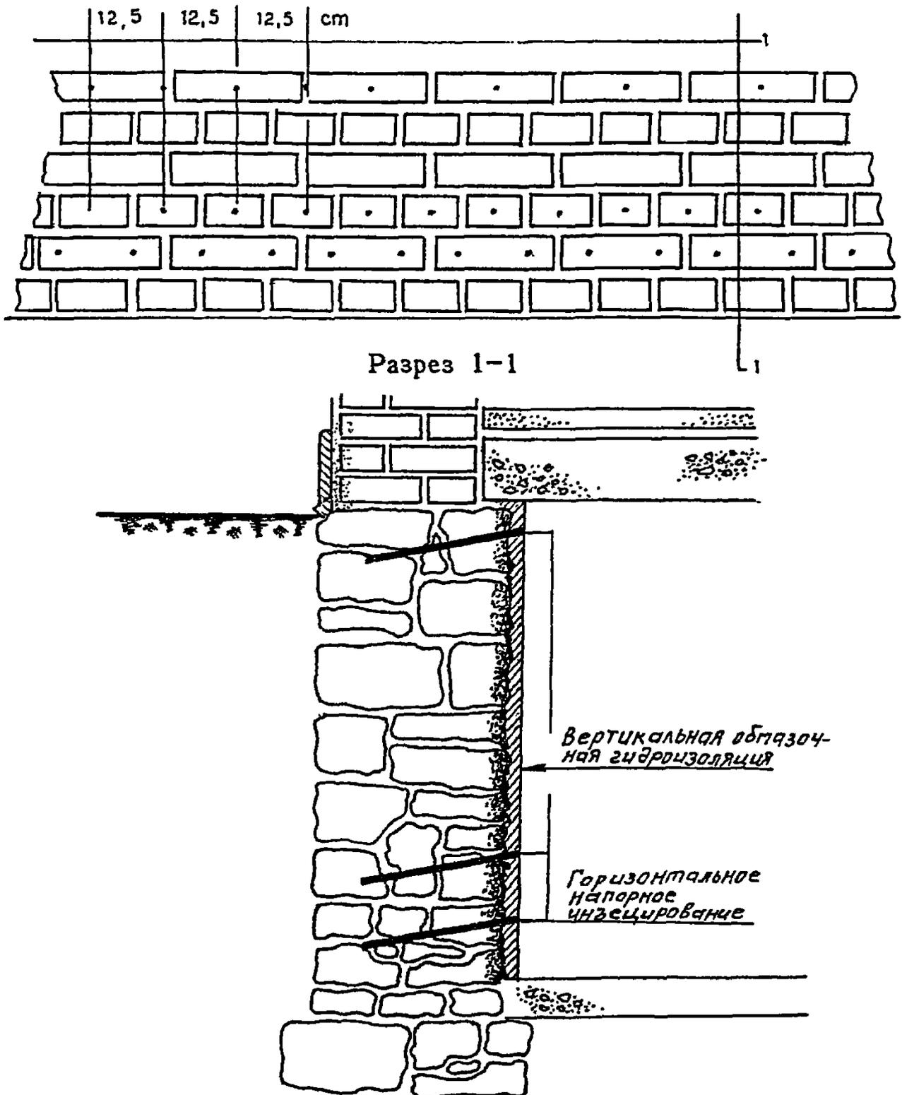
Рис. 3.3. Схема гидроизоляции подвала на объекте
