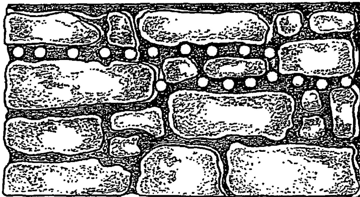
Рис. 3.1. Сверление отверстий в каменных конструкциях
