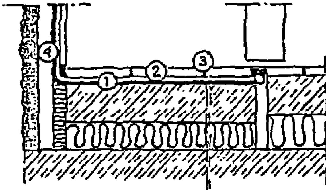
Рис. 4.3. Гидроизоляция под плитку. Капитальное строительство:
