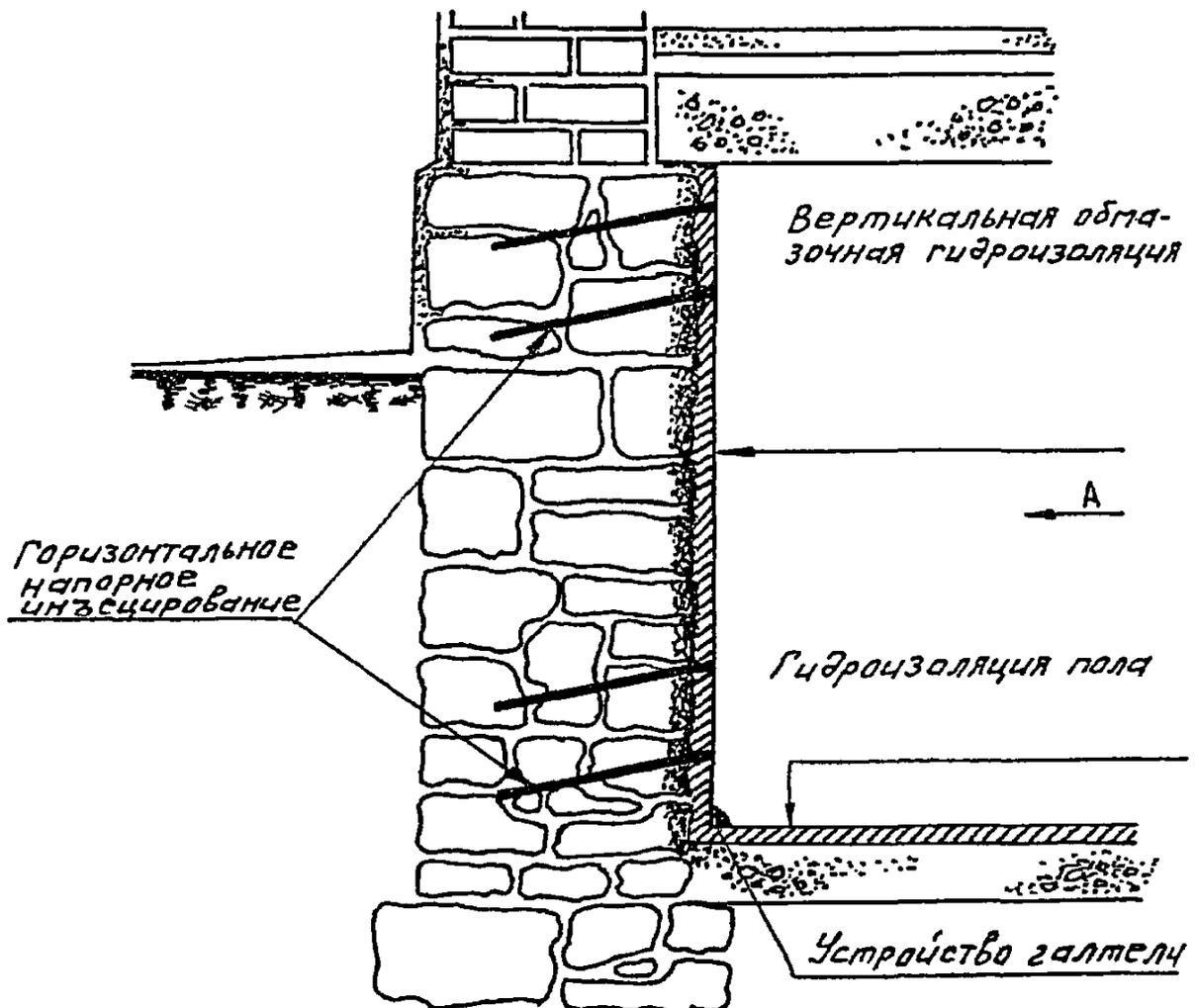
Рис. 3.4. Схема гидроизоляции подвала
