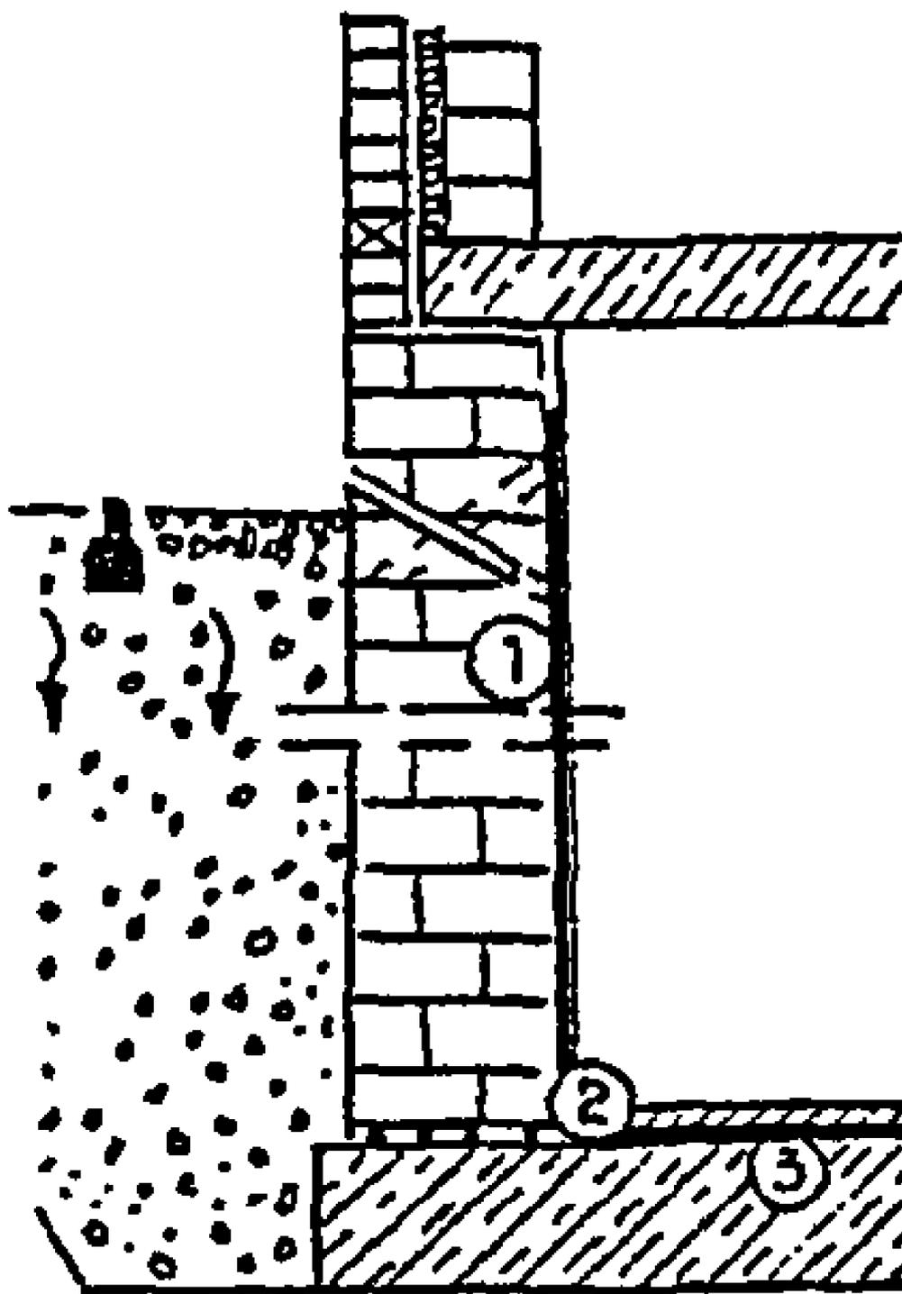
Рис. 4.2. Гидроизоляция подвалов изнутри в уже построенных зданиях:
