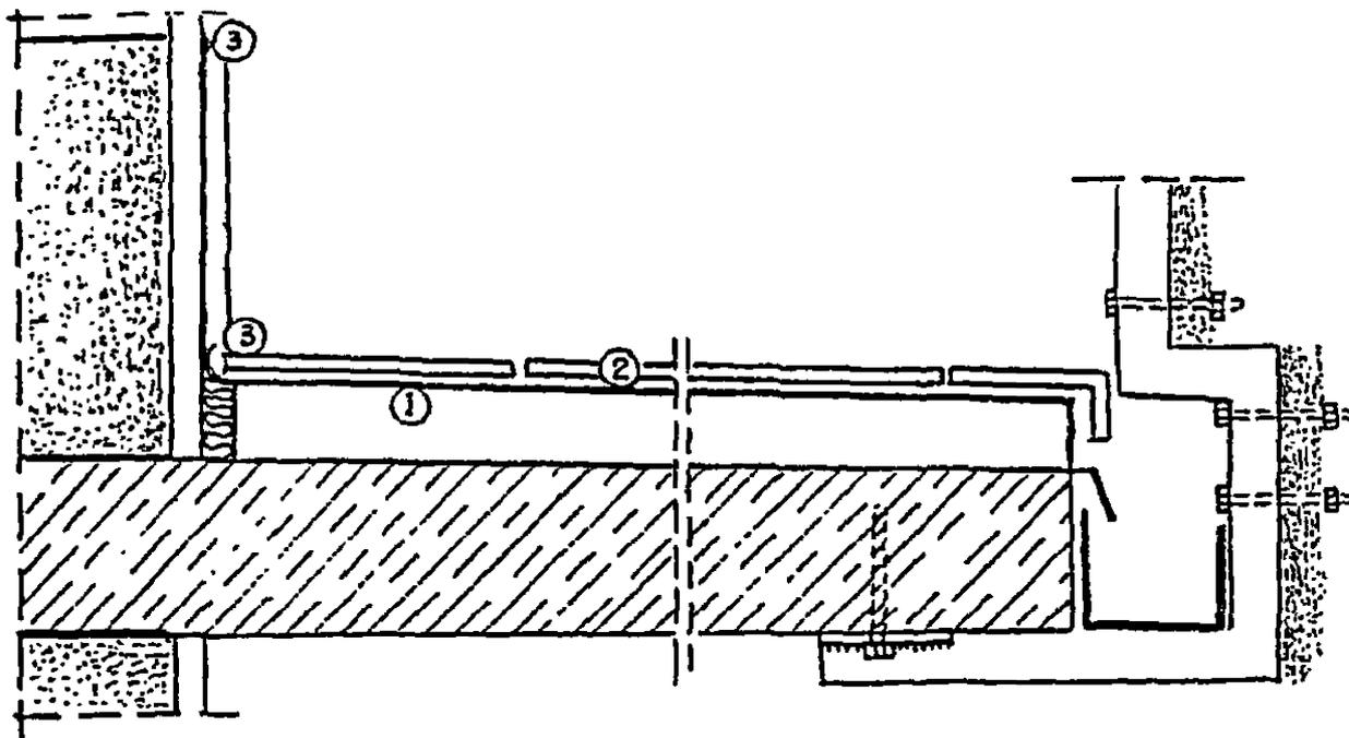
Рис. 4.9. Балконы и террасы. Гидроизоляция и ремонт:
