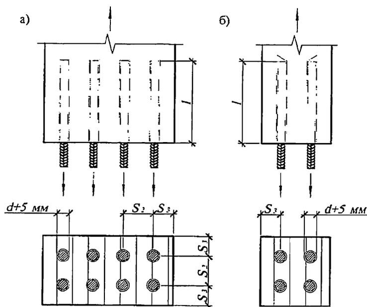
а – в цилиндрические отверстия; б – в профрезерованные пазы
