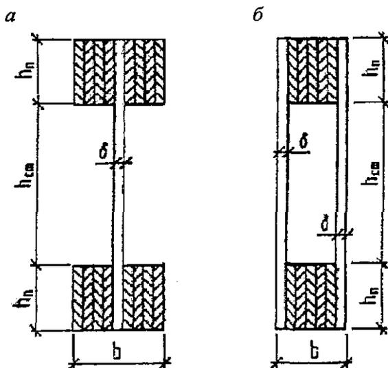
*a* – двутаврового сечения; *b* – коробчатого сечения
