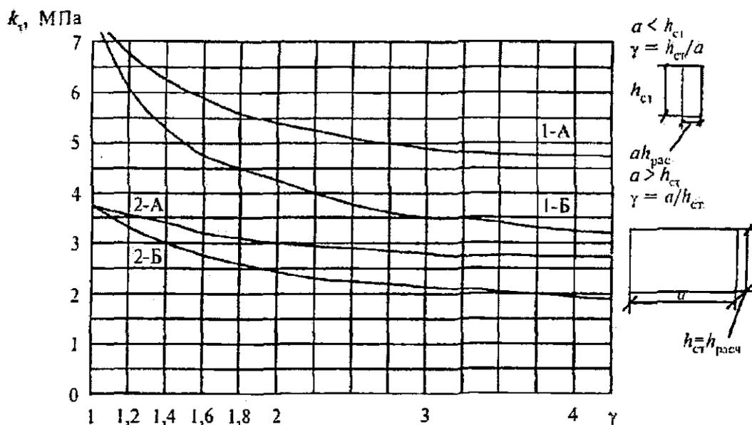
1-А – для бакелизированной фанеры марок ФБС и ФБСВ толщиной 7 мм и более при направлении волокон наружных слоев параллельно малой стороне панели; 1-Б – для бакелизированной фанеры марок ФБС и ФБСВ толщиной 7 мм и более при направлении волокон наружных слоев перпендикулярно малой стороне панели; 2-А, 2-Б – то же, для березовой фанеры марки ФБФ толщиной 8 мм и более
