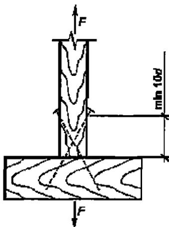
**Рисунок 16 – Наклонная забивка гвоздей**
