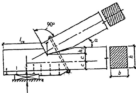
**Рисунок 8 – Лобовая врубка с одним зубом**
