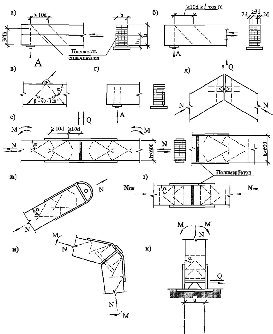
A – опорная реакция от расчетной нагрузки; a – в виде связей составных элементов; б – для повышения сдвиговой прочности клееной балки; в – для анкеровки закладных деталей; г, д – в опорных и других узлах конструкций; е – схема симметричного универсального жесткого стыка элементов сечением < 500 и > 600; ж – для растянутых элементов; з – для сжатых стыков с полимербетоном; и – для полигональных элементов, несимметричная схема (карниз рамы); к – для узла защемления стоек
