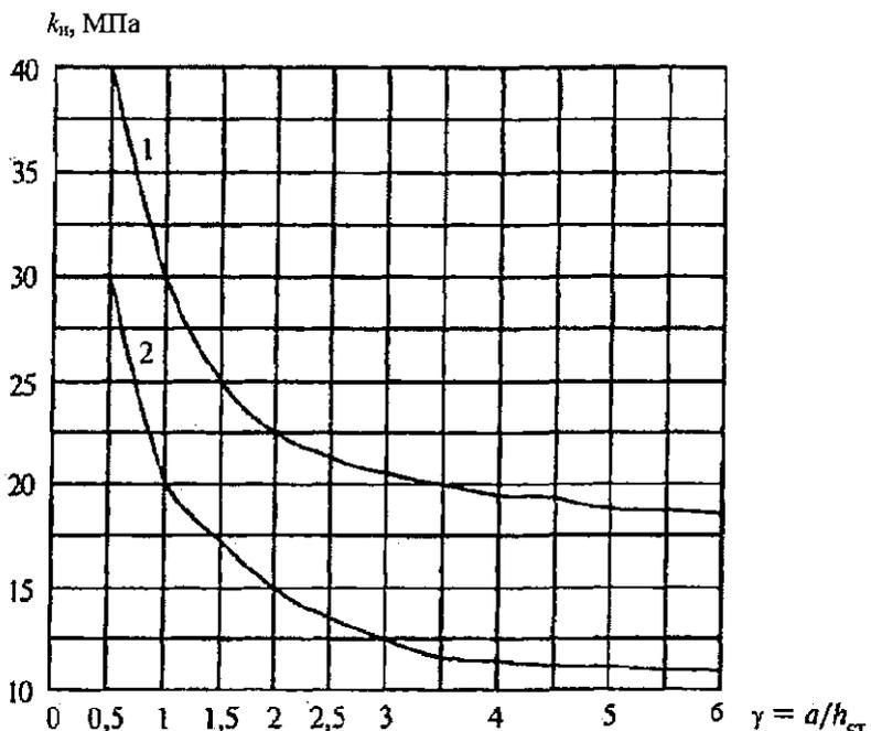
1 – для бакелизированной фанеры марок ФБС и ФБСВ толщиной 7 мм и более; 2 – для березовой фанеры марки ФБФ толщиной 8 мм и более. В выражении  $\gamma = a/h_{ct}$   $a$  – расстояние между ребрами жесткости балки;  $h_{ct}$  – высота стенки между внутренними гранями полок
