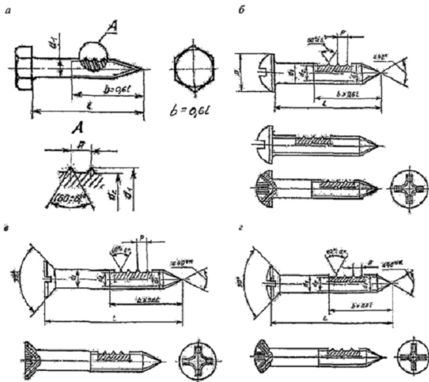
*а* – глухарь (ГОСТ 11473); *б, в, г* – шурупы с полукруглой (ГОСТ 1144), потайной (ГОСТ 1145) и полупотайной (ГОСТ 1146) головками
