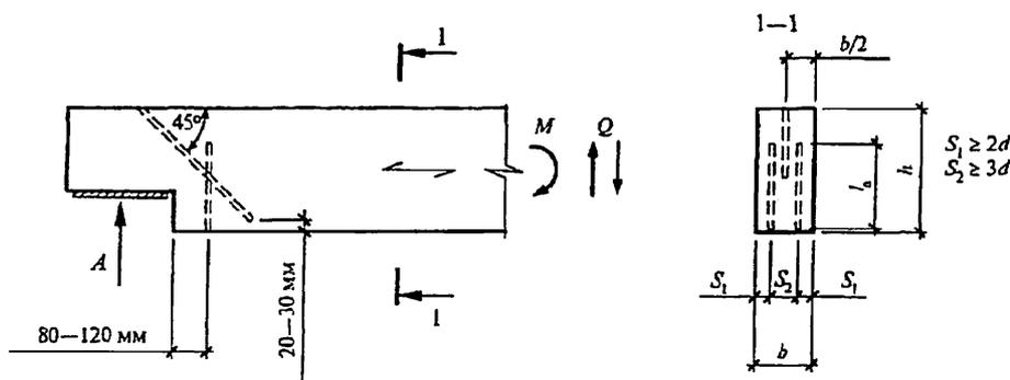
**Рисунок 22 – Усиление подрезки на конце балки**
