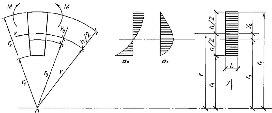
Рисунок 3 – Расчетная схема кривого бруса при чистом изгибе
