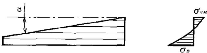
**Рисунок 23 – Односкатная балка**
