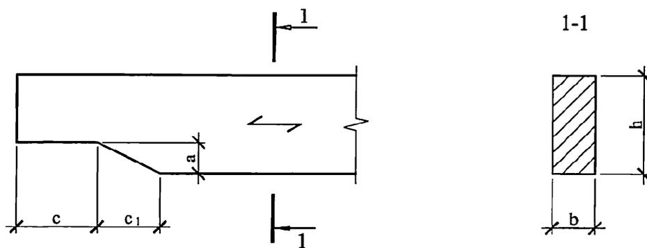
**Рисунок 21 – Скошенная подрезка конца балки**
