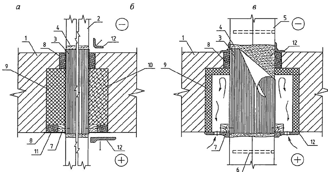
*а* – с утеплением зазоров плитным утеплителем; *б* – то же, заливочным пенополиуретаном (ППУ);
