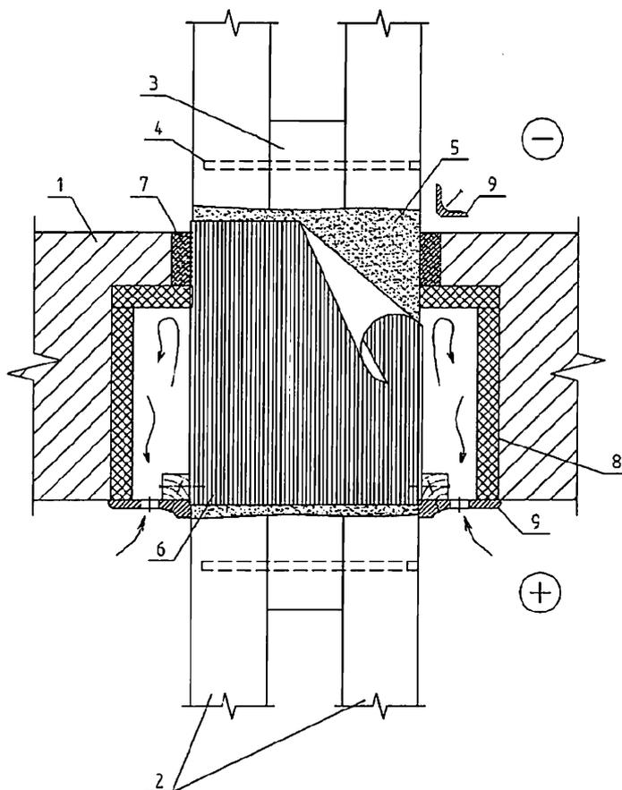
1 – наружная стена; 2 – спаренная несущая КДК; 3 – вставка; 4 – клеенный металлический стержень; 5 – поверхность, обработанная антисептиком; 6 – влагоизоляционный бандаж; 7 – монтажная пена; 8 – плитный утеплитель; 9 – нащельник
