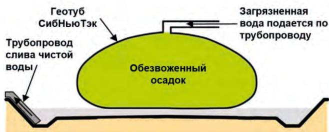
Компания «СибНьюТэк» предлагает специальную конструкцию геотубов «Сибньютэк®» с усилением строповыми ремнями, применение которых позволяет использовать контейнер для транспортировки даже не обезвоженной буровой пульпы при проведении буровых работ.
