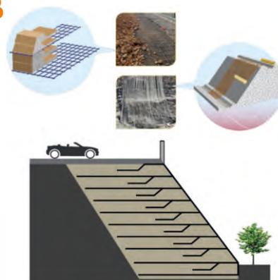
Полиэстерное полотно может быть уложено в виде покрытия откоса (горной массы) для достижения эффекта укрепления, необходимого для предотвращения повреждения, выветривания, обрушения, вибрационного повреждения и т.д. или осуществляется строительство армированной почвенной структуры из полиэстерной сетки для обеспечения поддерживающего эффекта.
