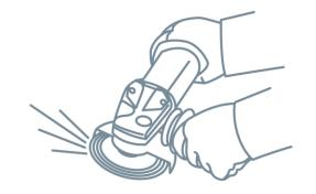
Допускается механическая очистка до степени St 2 по ISO 8501-1 с последующим обезжириванием.
