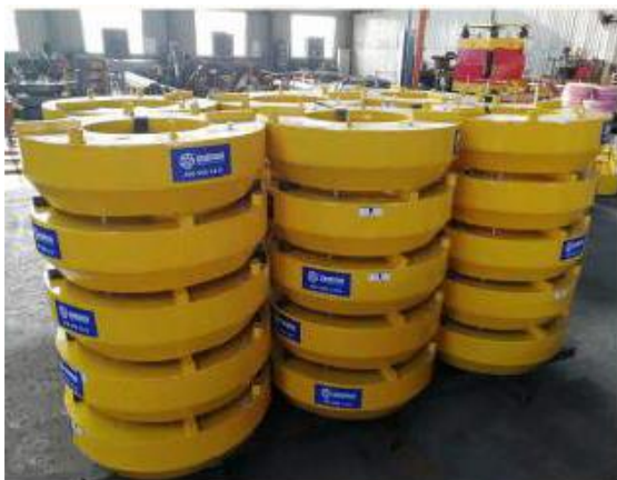
Рис.5 Готовые модули (двунаправленные испытания свай погружными домкратами) для установки в сваи по методике Bi-directional test .
