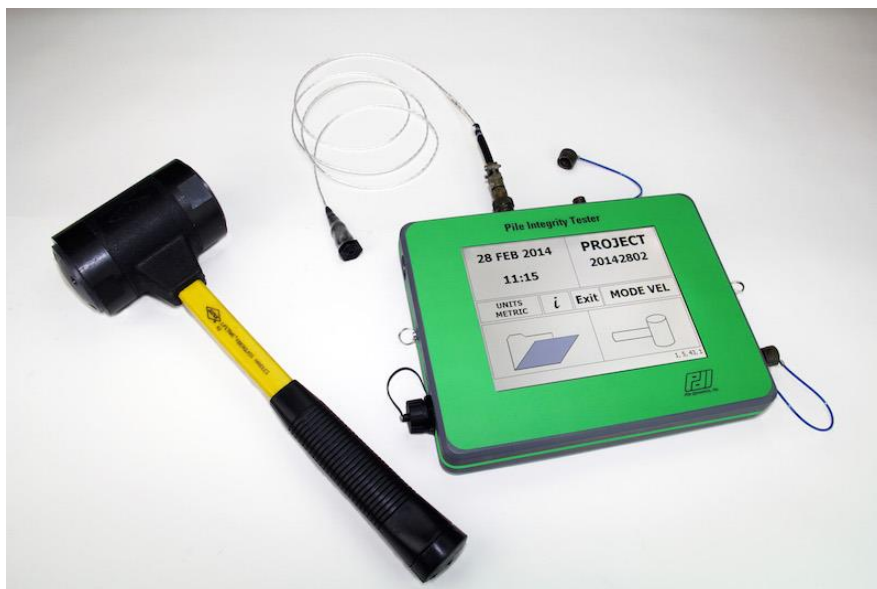
Рис. 1. ПИТ (pile integrity tester) проверка сплошности свай фирмы Pile Dynamics, Inc. имеющий стандарт для испытания ASTM D5882.
