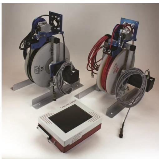
Рис.2 Прибор CHAMP ASTM D6760 для сквозного прозвучивания ультразвуком
