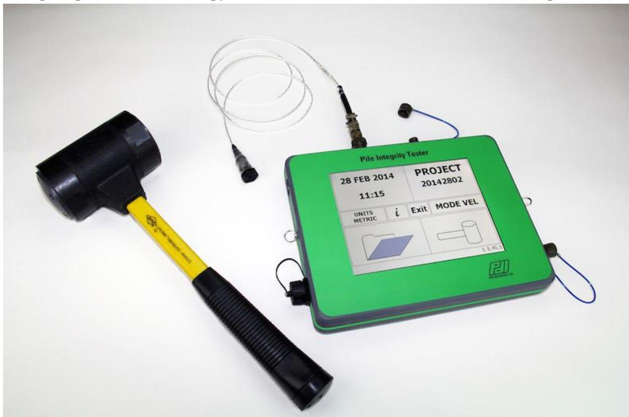
**Рис. 1. PIT (pile integrity tester) проверка сплошности свай фирмы Pile Dynamics, Inc. имеющий стандарт для испытания ASTM D5882.**
