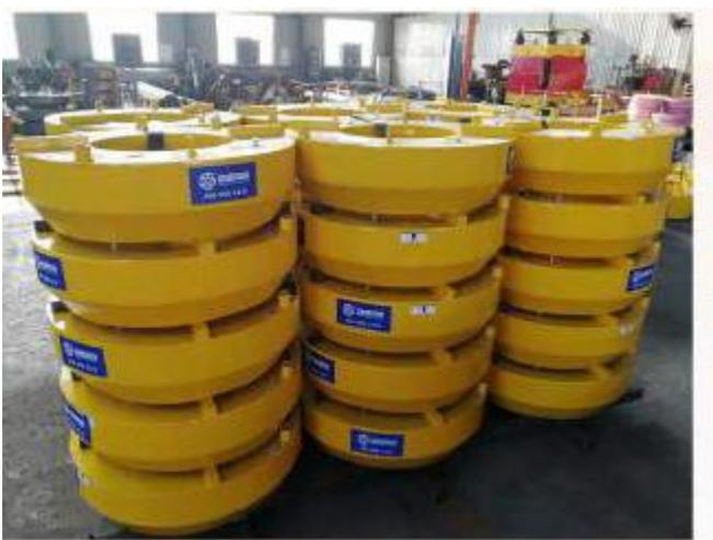
**Рис.5** Готовые модули (двунаправленные испытания свай погружными домкратами) для установки в сваи (Китай) по методике Vi-directional test.
