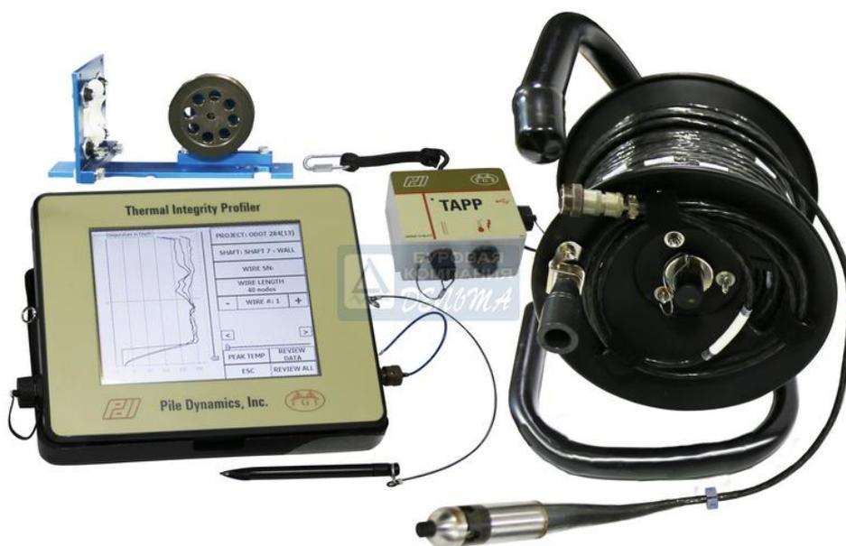
**Рис. 3** Прибор для оценки теплового профиля ТИР
