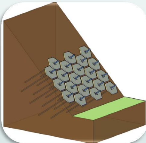
Нагельное крепление с прижимными плитами
