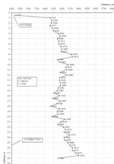
Рис. 3. График «Скорость ультразвука по длине сваи» БНС №4 опоры №3 Объект: «Эстакада автомобильной дороги «Джубга-Сочи» на участке обход г. Сочи (р. Сочи).
