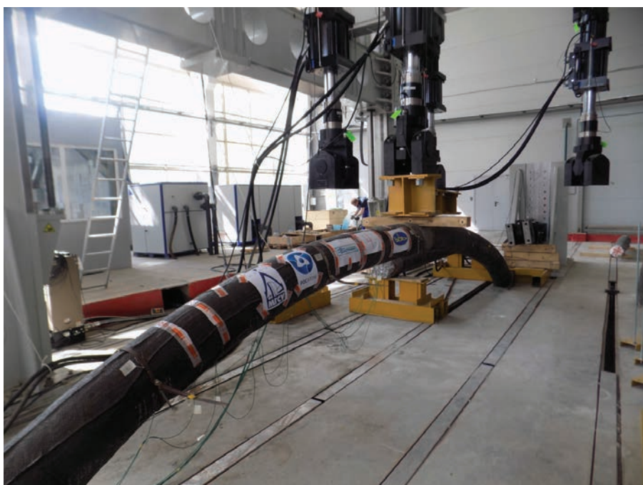
Рис. 4. Испытание конструктивно-подобного арочного несущего элемента
