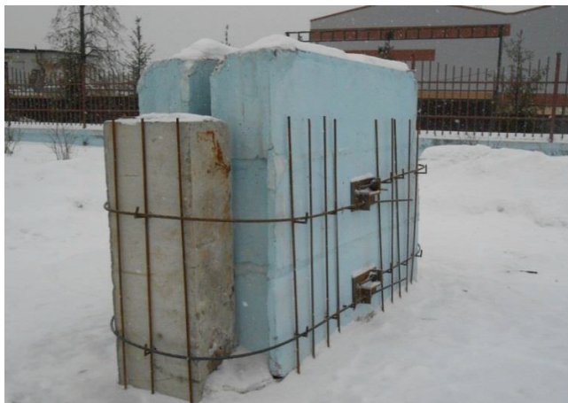
Рис 10. Макет усиления опоры высокопрочной прядевой арматурой
