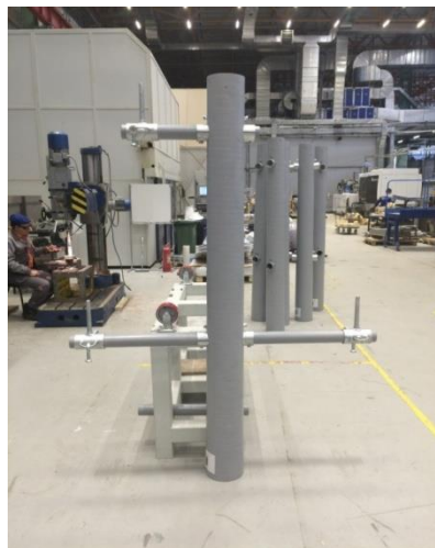
Верхняя секция ПК10-2. Контрольная сборка
