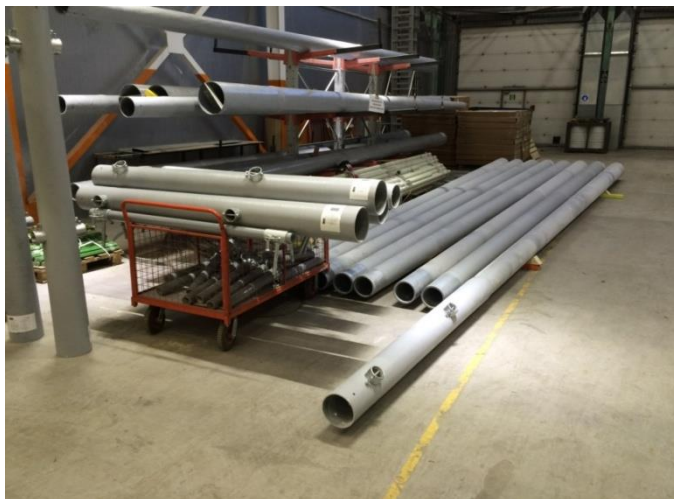
Контрольная сборка композитных опор ПК10-2
