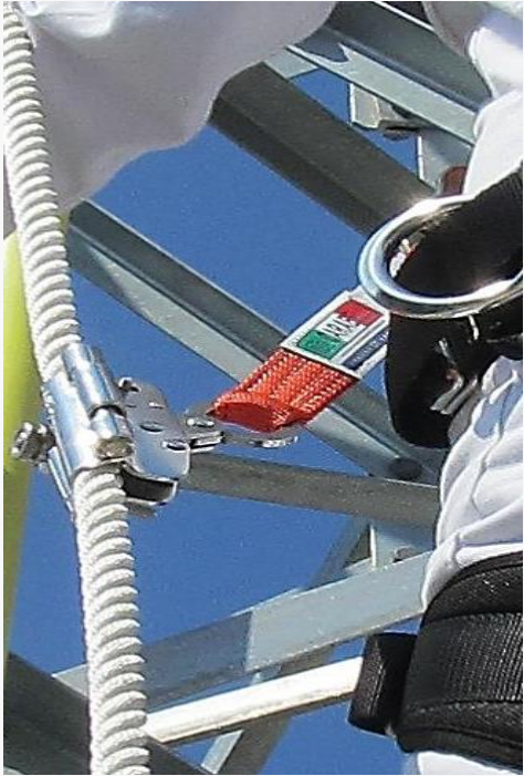
Рис. 11 Устройство ползункового типа АРТ. 3408CENTR
