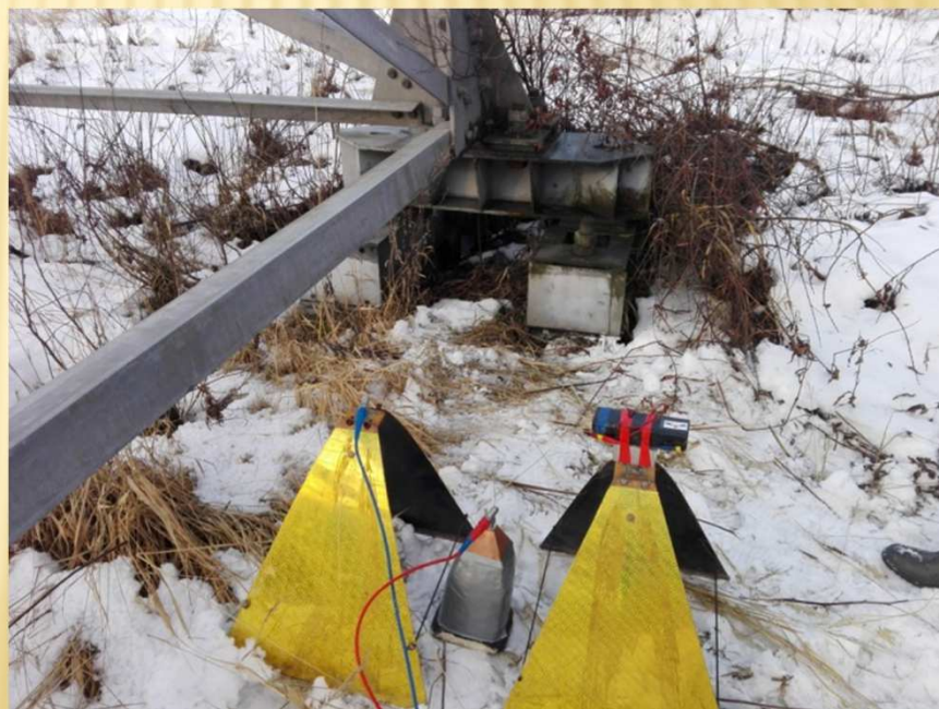
Комплекс «Геодизонд-1» в пункте зондирования ТЗ-4 в 1.5 м от сваи
