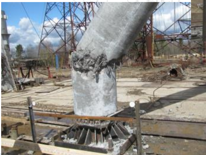
Разрушение стойки СЦС20 В 60.2 (160%)
