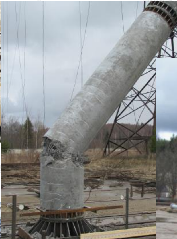
Разрушение стойки СЦС20 В60.1 (160%)
