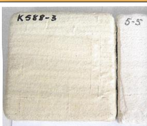
Рис. 4 Внешний вид защитного покрытия - образец К 588-3 – контрольный; - образец 5-5 - после 75 циклов климатиче
