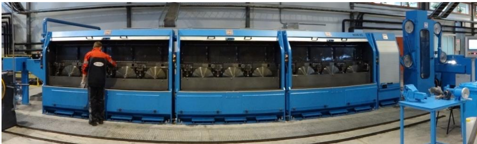
Волоочильная машина “NIENOFF” (Германия)
