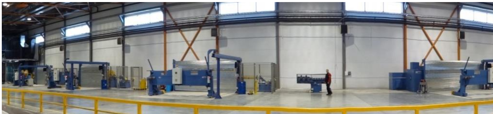
Крутильная машина фонарного типа “POURTIER” (Франция)
