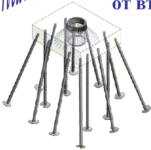
Фундамент из винтовых свай для многогранной опоры
